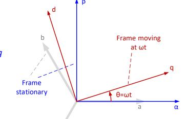
$$\bullet \begin{bmatrix} V_q \\ V_d \end{bmatrix} = \begin{bmatrix} \cos\theta & \sin\theta \\ -\sin\theta & \cos\theta \end{bmatrix} \begin{bmatrix} V_{\alpha} \\ V_{\beta} \end{bmatrix}$$
